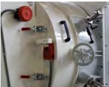
Seguridad sobre puertas eléctricas
