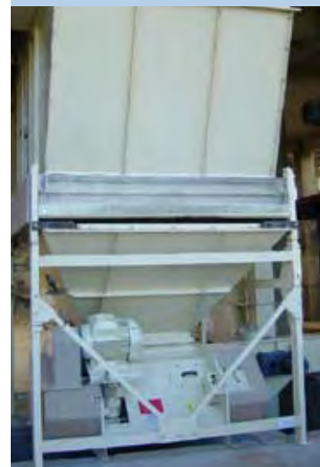
Desmigador bajo enfriador
